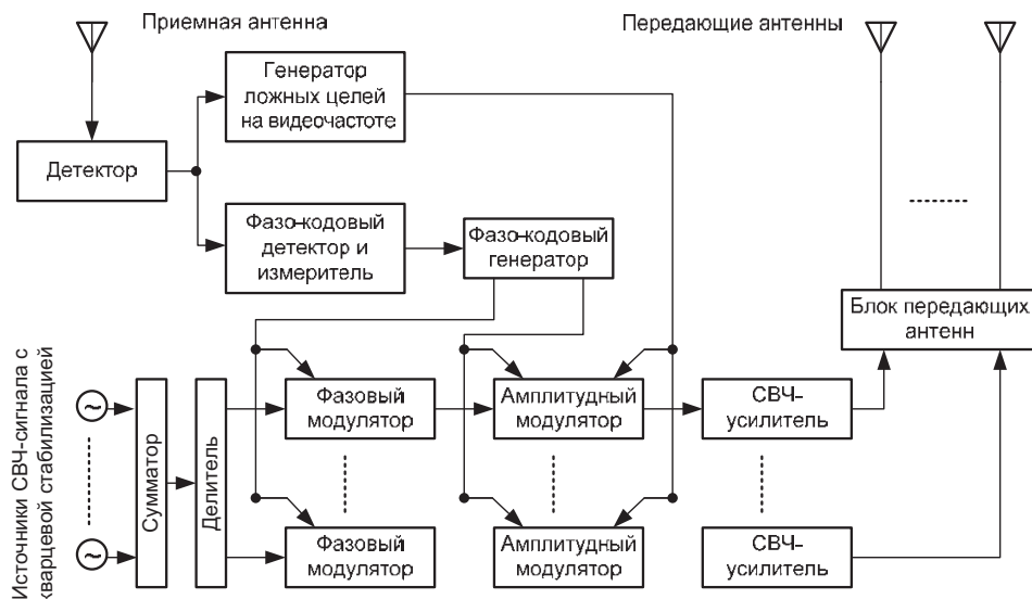
Рис. 11.19. Структурная схема передатчика ложных целей, создаваемых радиолокаторам с частотной перестройкой и фазово-кодовой манипуляцией сигналов
