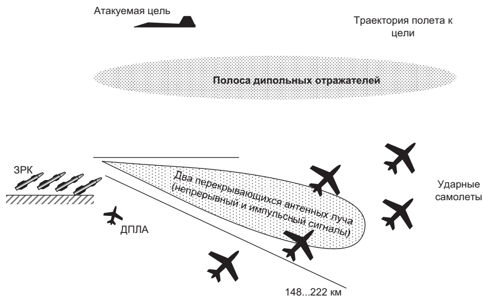
Рис. 5.11. Тактическая ситуация, иллюстрирующая способ РЭП двухканальной системы сопровождения, использующей одновременно импульсное и непрерывное излучение
